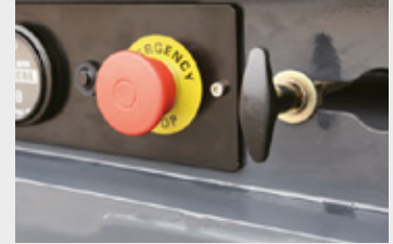
Sistema de Descenso de Emergencia
